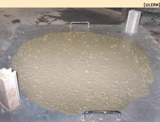
Mesure de l'étalement d'un Bap au cône d'Abrams.
