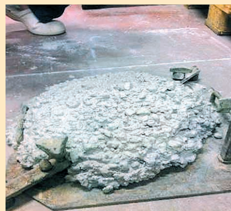
Béton de classe de consistance S5 déterminée par mesure de l'affaissement au cône d'Abrams.
