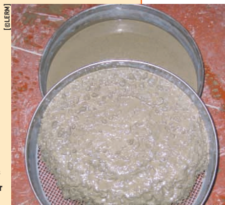
Mesure de la stabilité au tamis pour appréhender la cohésion.
