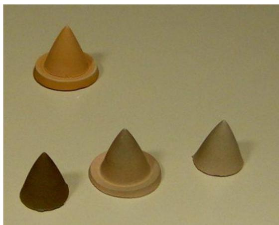
*Essais de valorisation de sédiments fins en tant que matière première à l'industrie de la terre cuite : Coulage de barbotine en moule de plâtre (taux d'incorporation de sédiments atteignant 100 % pour le sédiment isérois) ; Mise au point de pâtes plastiques pour la réalisation de produits de type briques. © EDF R&D*
