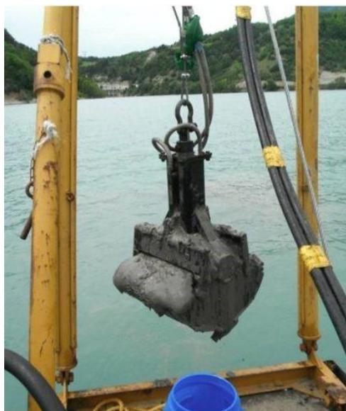
Prélèvement de sédiments fins pour essais (Alpes) © EDF R&D
