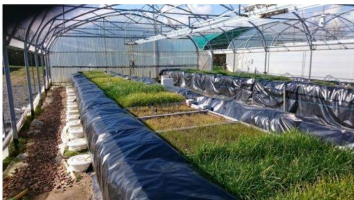
*Essais de construction de sols fertiles à partir de sédiments fins de barrage en lysimètres (Agrocampus Ouest, Angers) © EDF R&D*
