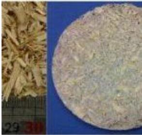
**Fibres végétales et matrice cimentaire.** L'idée de reprendre une technique traditionnelle, le renforcement par fibres végétales, dans un contexte de matrice à liant hydraulique, a déjà donné lieu à de nombreuses avancées...
