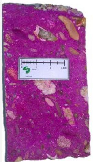
Frange carbonatée très réduite, entre 0 et 3 mm de profondeur (Test à la phénolphthaléine sur fracture fraîche)
