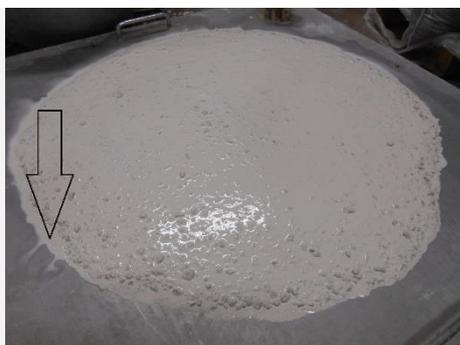
Phénomène de ressuage (=>) (avec remontée de laitance) sur un béton auto-plaçant (BAP)
