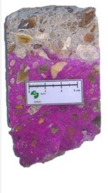
Carbonatation d'un béton sur une profondeur de 25 à 30mm (zone non colorée, partie haute – Test à la phénolphthaléine sur fracture fraîche)
