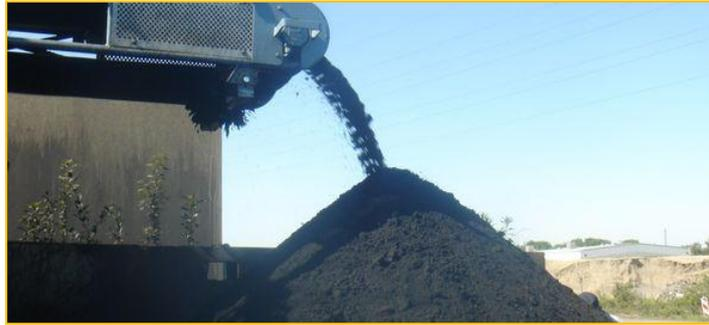
Leur utilisation en couche de forme doit le plus souvent s'envisager soit avec un traitement aux liants hydrauliques, soit avec une activation calcique.
